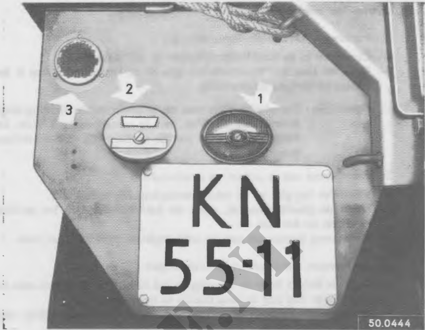
Afb. 91. Normale en verduisterde stopachterlamp gecombineerd met richtinglamp (achterzijde).
