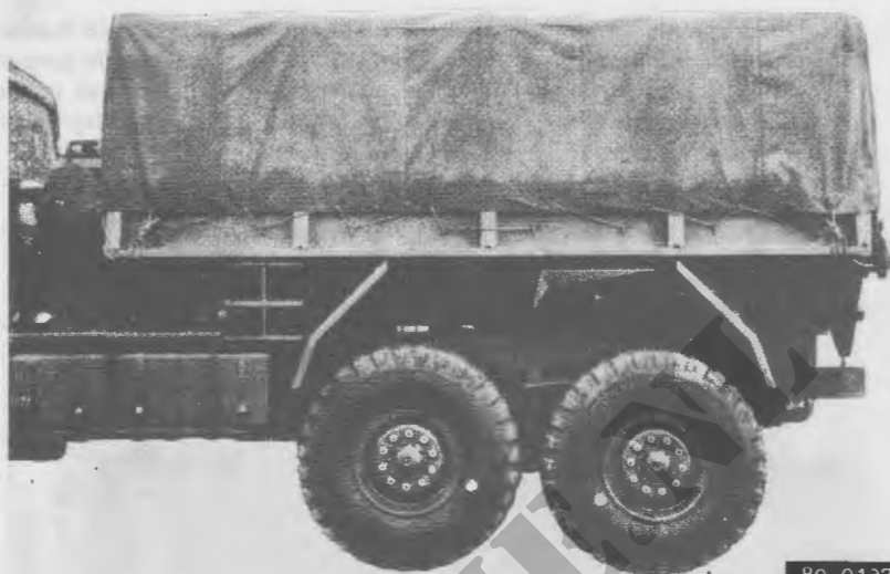
Afb. 179. Spannen van laadbakzeil aan zijkant.
