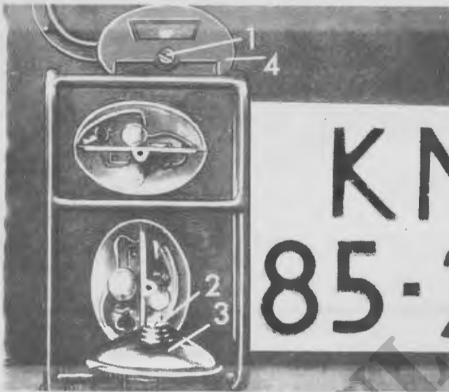
Afb. 36. Vervangen van gloeilamp normale en verduisterde stop-achterlampen.
