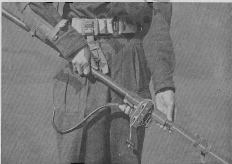
Figuur 10. Bevestiging hanger en armkussen PMD 3
