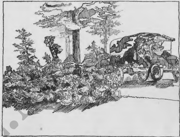
Vrachtauto met grootvlekkige beschildering, loop van een vuurmond met kleinvlekkige beschildering en vormverminkende aanhangsels.
