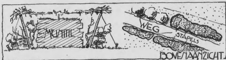
Fig. 87. Maskeering van munitiestapels of materialen in den stellingoorlog.
