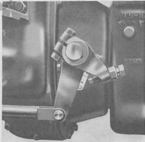
Afb. 2. Afstelling vrije slag van het koppelingpedaal.
