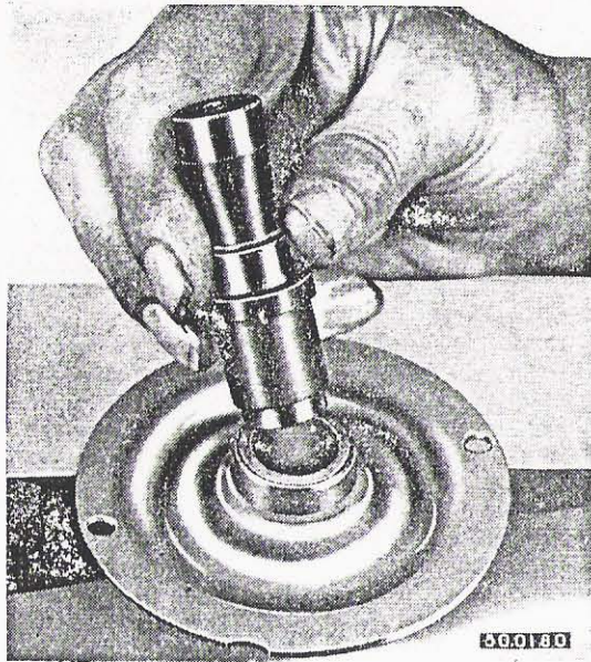
Afb. 82. Uitdrukken lagerbus met uitdrukdoorn
