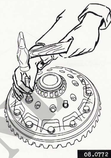
Afb. 81. Aanbrengen van de pasbouten
