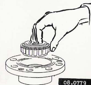
Afb. 59. Verwijderen van de binnenloopring uit het lagerhuis
