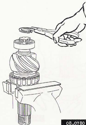
Afb. 71. Aanbrengen borgveer cilindrisch rollager
