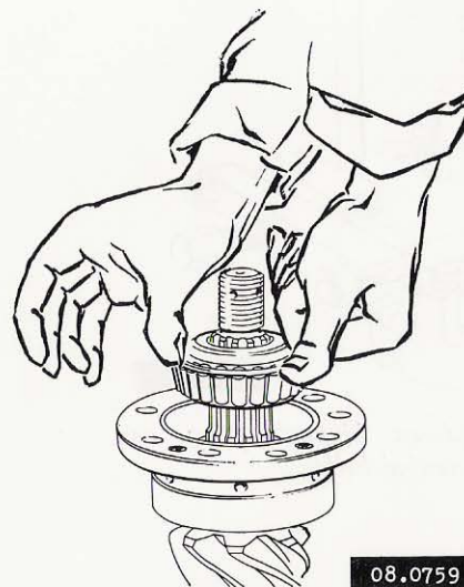
Afb. 75. Aanbrengen binnenloping in lagerhuis
