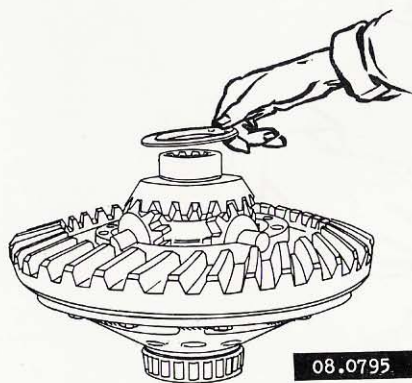
Afb. 64. Verwijderen cq aanbrengen van de drukring op het planeetwiel
