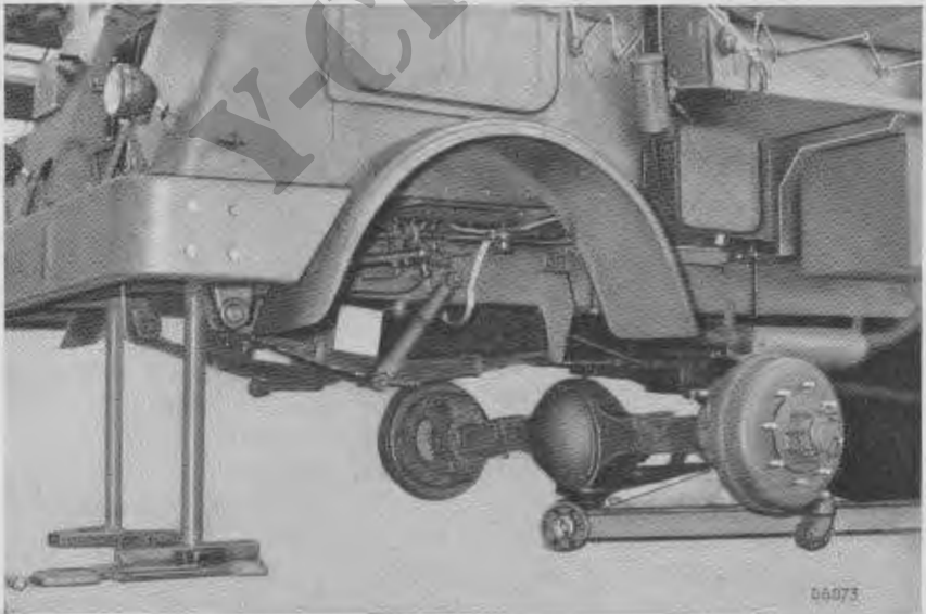
Afb. 74. Verwijderen van de voorbrug.
