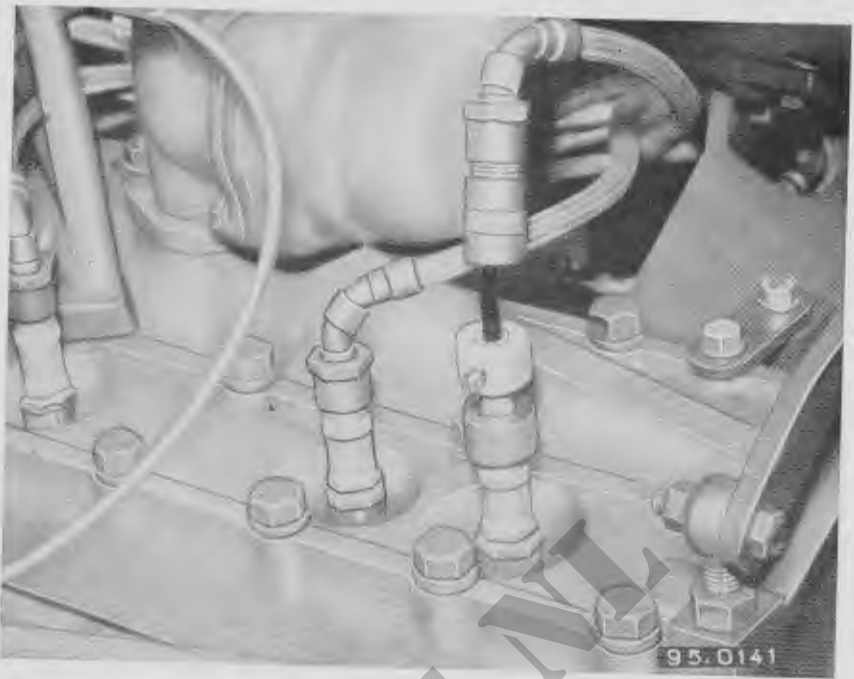
Afb. 57. Bougie hulpstuk voor aansluiten van neon afstellamp, geplaatst tussen bougiekabel en bougie van eerste of zesde cylinder.
