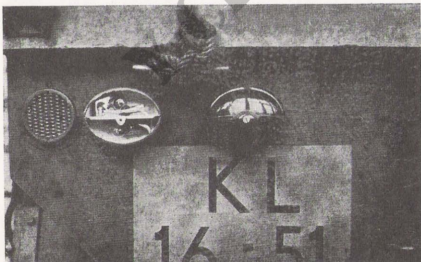
Afb. 136. Normale en verduisterde stop-achterlamp (verduisteringskap afgenomen).
