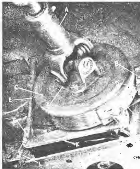
Afb. 115. De handrem in het voertuig gemonteerd.
