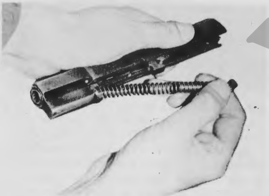
Figuur 11 Verwijderen van de sluitveer en sluitveerstang
