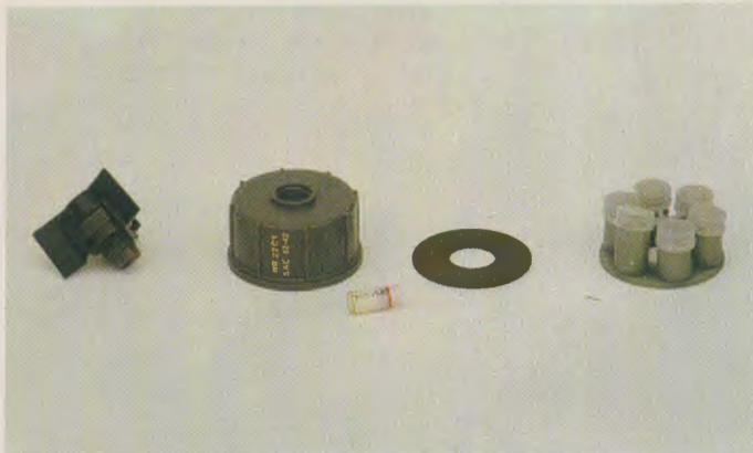
Fig. 16-6 Uiteenname voor controle Inktpotmijn AP nr. 22C1 met drukontsteker nr. 22C2 en slagpijpje nr. 30C1
