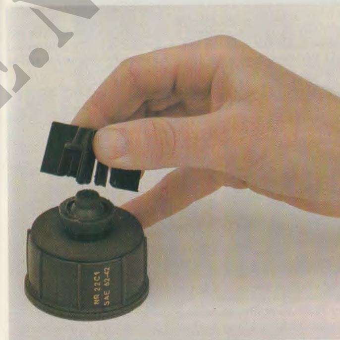
Fig. 16-7 Ontgrendelen van de inktpotmijn AP nr. 22C1; alleen in geplaatste toestand
