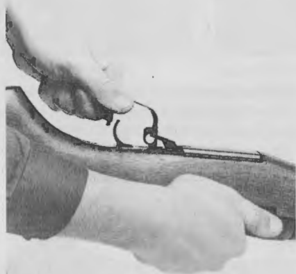
Figuur 15 Verwijderen van de afvuurinrichting
