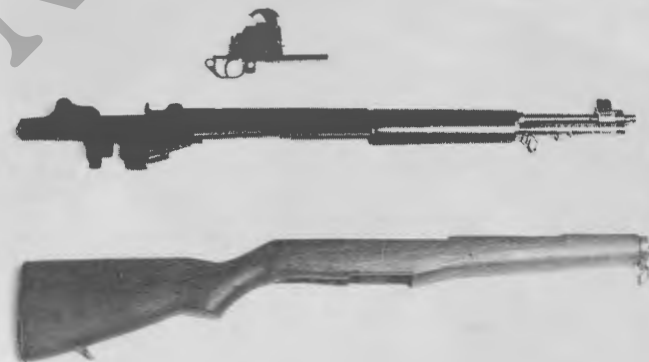
Figuur 17 De hoofdgroepen 1. Afvuurinrichting 2. Loop met staartstuk 3. Lade
