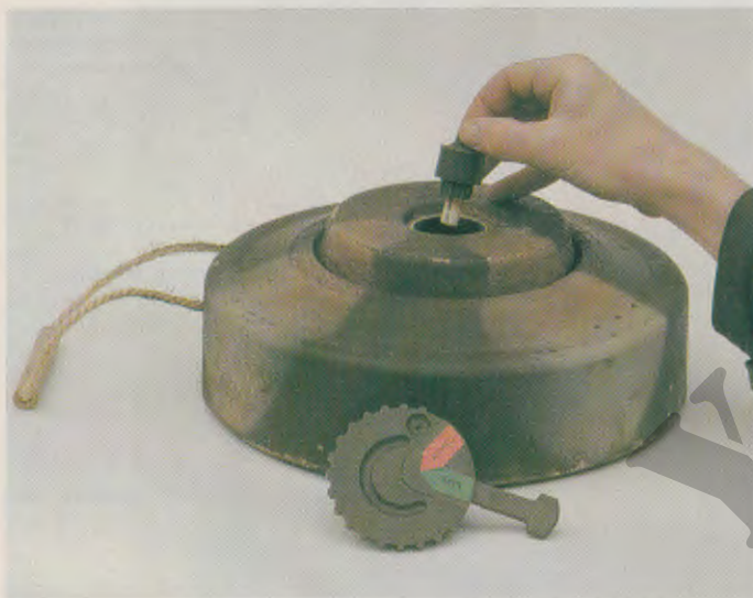
Fig. 16-4 Gebruiksgereed maken van Trotylmijn AT nr. 26C1
