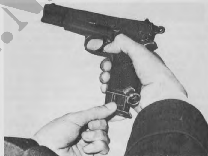
Figuur 8 Verwijderen van het patroonmagazijn
