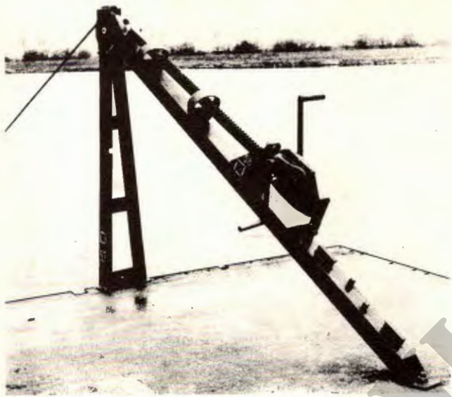
fig. 18a oprittieren met lierkabels
