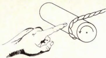
fig 4a Linksgeslagen draad Rug linker hand boven, bij boven langs opwikkelen. Rug linker hand omlaag, bij onderlangs opwikkelen.
