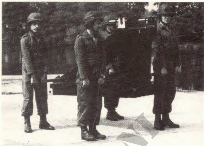
De oeverwarsdrager (fig. 7). De oeverwarsdrager heeft een gewicht van 285 kg en wordt door 6 man gedragen.
