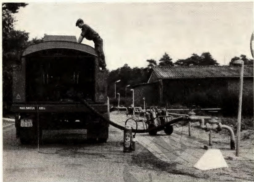
Brandblusapparaat aanwezig Let op het gebruik van de aardklem voor afvoer van inductiespanning
