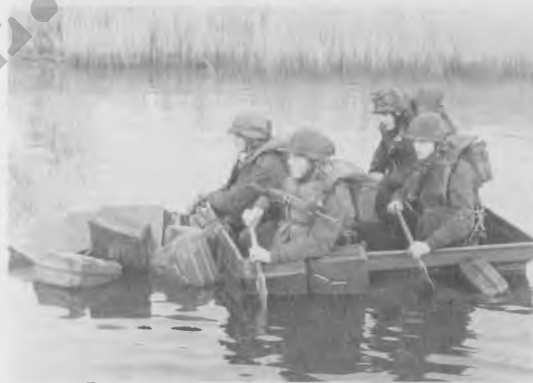
Fig. 8. Overvaren van 1/4-ton trailer op eigen drijfvermogen en aangevuld met 18 jerry-cans
