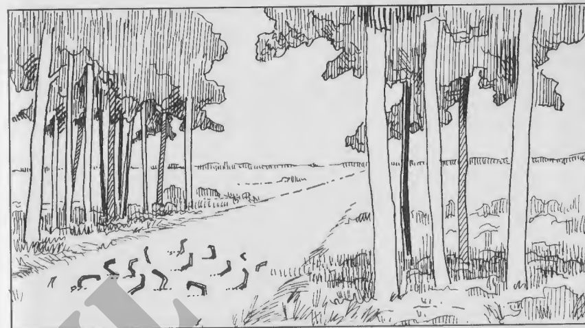
Fig. 6 Schijnmijnafsluiting met stukken betonijzer \pm 20 cm boven maaiveld uitstekend
