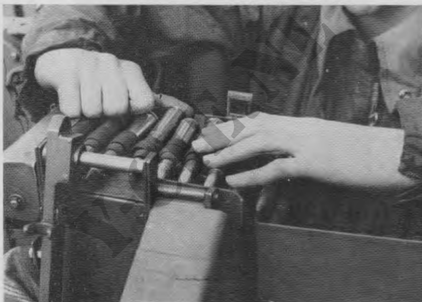
Figuur 11 Losse patroon wordt in de schakel gedrukt
