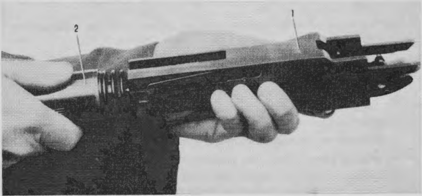
Figuur 14 Uitnemen van de remcilinder uit de buffer 1. Bufferhuis 2. Remcilinder
