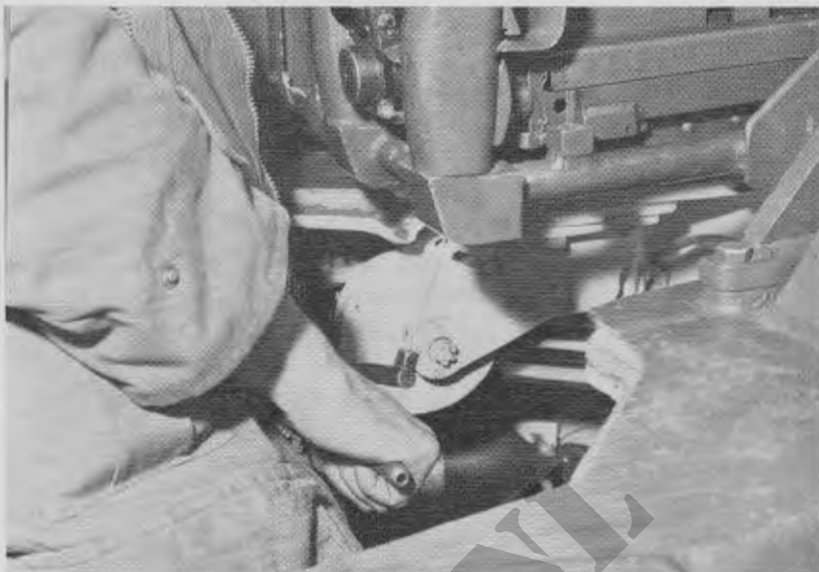
Figuur 13 Het spannen van het wapen m.b.v. de spaninrichting M 10
