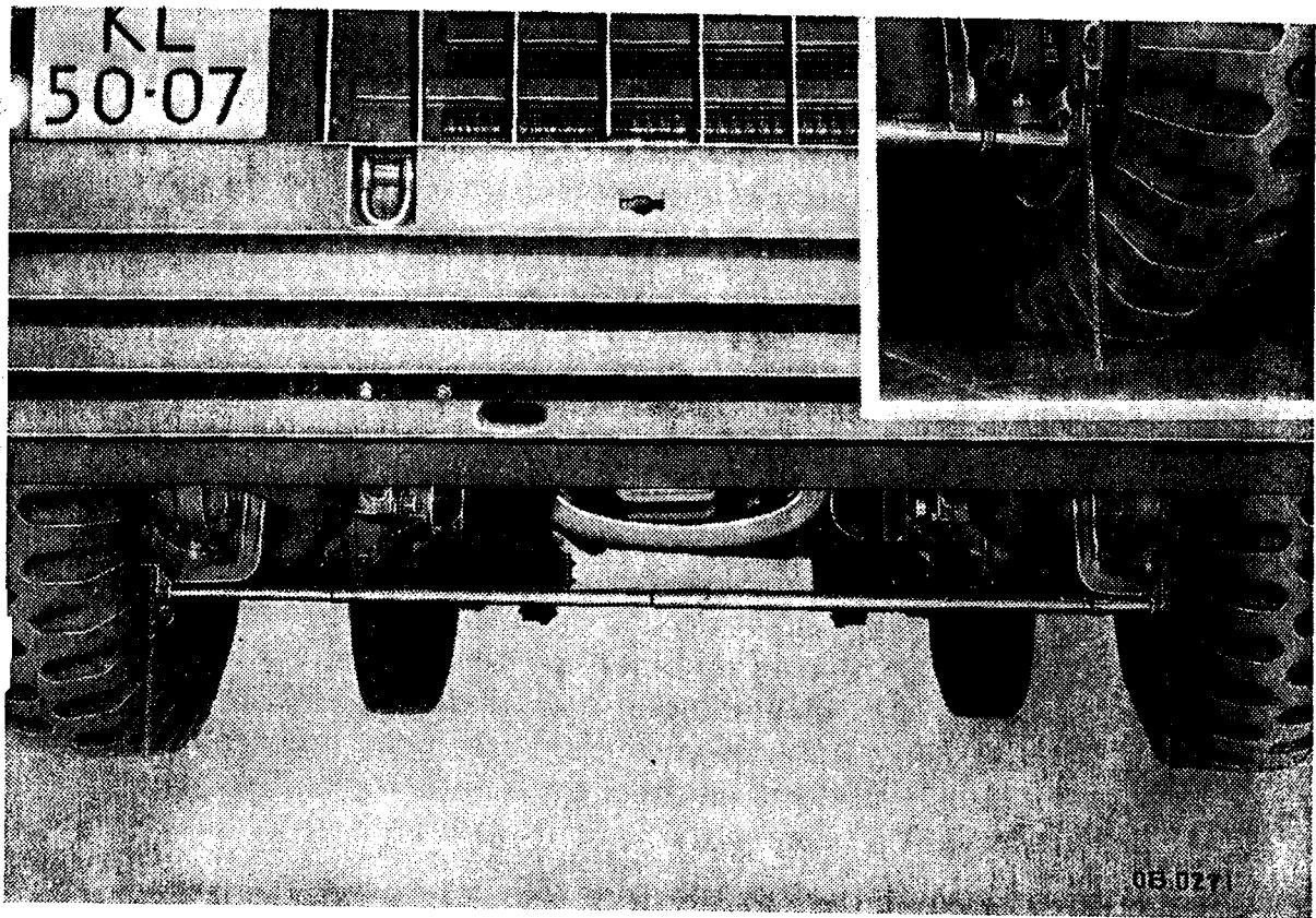
Afb. 112. Controle van de toespoor met een spoorstok.
